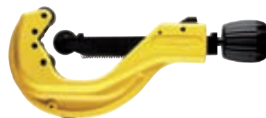
Viega csővágó műanyag csövekhez. Két méretben kapható: 14–40 mm és 25–63 mm közötti méretekhez.
