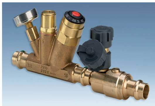
4. ábra. Az egyes leágazások DVGW W 553-as munkalap szerinti termikus korrekt kiegyenlítéséhez jól beváltak az automatikus cirkulációs beszabályozó szelepek. Különösen azért, mert olyan automatikus kapcsolással rendelkeznek, mely leegyszerűsíti a termikus fertőtlenítést, és még a térfogatáramot is szabályozza
