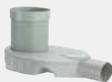
Advantix lefolyó - a következőkhöz: Advantix saroklefolyó - állítható építési magasság Kialakítás/felszereltség visszatorlódásbiztos és 35–50 mm között állítható záróvíz, csatlakozó-vezeték tisztítási lehetősége, magasságkiegyenlítő elem, merülőcső, szűrőbetét műszaki adatok lefolyási teljesítmény (DIN EN 1253 szerint) 0,8–2,2 l/s modellszám 4973.90
