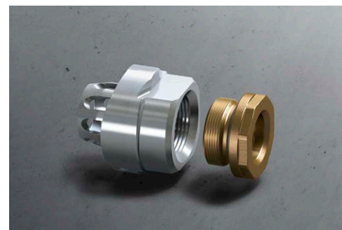
A leágazóidom alkalmas DIN EN 10255, DIN EN 10220/10216-1 vagy DIN EN 10220/10217-1 szabvány szerinti acélcsövekhez és 1½, 2, 2½, 3, 4, 5 és 6 colos méretekben érhető el. A préscsatlakozó Rp ¼ colos belső menettel rendelkezik. Az Rp ½ colos belső menethez szükséges szűkítőidom külön érhető el.
