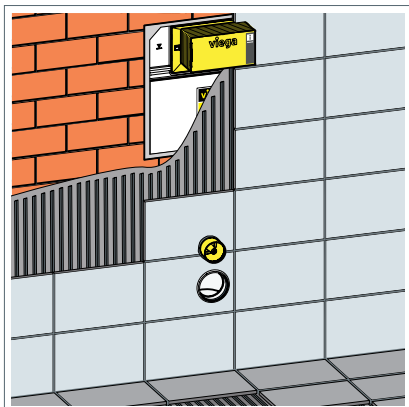
53. ábra: Teljes felépítés Prevista Pure öblítőtartály modell 8502 álló WC-vel kombinálva
