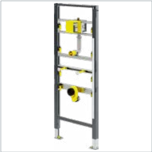
161. ábra: Prevista Dry vizeldelem, vízcsatlakozás teleszkópozható (modell 8560)
