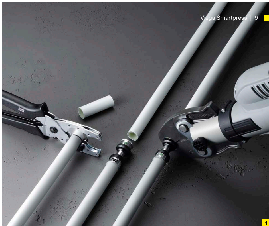
Nincs szükség időigényes kalibrálásra: méretre vágás, rátolás, préselés és kész.
