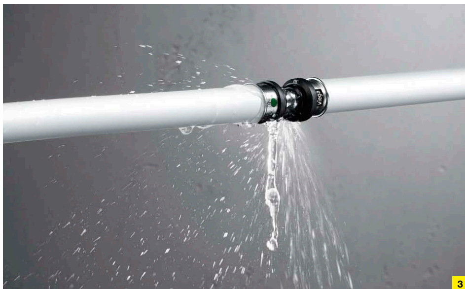
Maximális biztonság: Az SC-Contur megbízhatóan megmutatja a véletlenszerűen préselés nélkül hagyott présidomokat.
