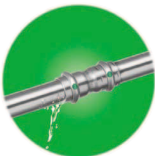
Viega Sanpress Inox SC-Contur-al (biztonsági kontúr): préselés nélkül = a rendszer feltöltésekor láthatóan nem tömör.
